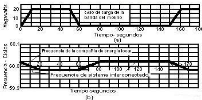
Fig. 3.19 (a) la carga de molino de tira Caliente. (b) el Efecto en la frecuencia de sistema interconectado grande.
